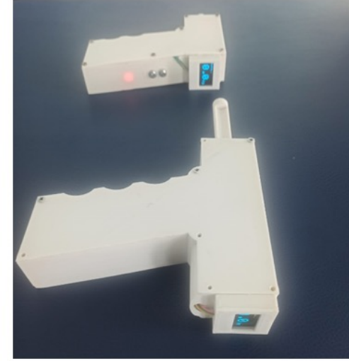
Prototip olarak geliştirdiğimiz Algometer Cihazı (Ağrı eşiği ölçer)
